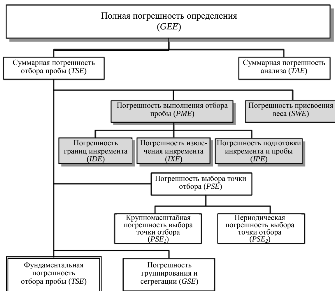
Рисунок 3. Классификация погрешностей отбора пробы по теории отбора проб Ги
