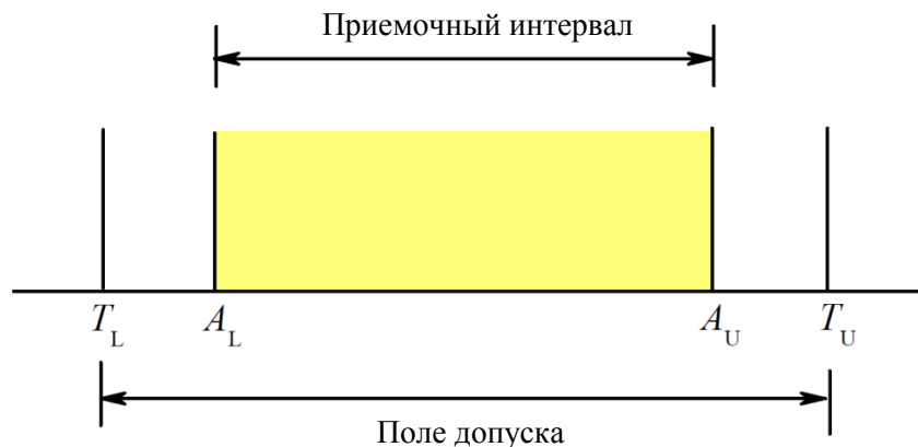
Рисунок 1 – Двойная оценка соответствия, когда решения основываются на измеренных значениях величины. Истинное значение измеряемого свойства (измеряемой величины) объекта должно лежать в пределах поля допуска, задаваемого границами ( T_L , T_U ). Объект признается годным, если измеренное значение свойства лежит в интервале, ограниченном приемочными границами (см. 3.3.8) ( A_L , A_U ), в противном случае он бракуется.
