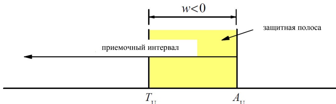
Рисунок 11 – Правило приемки, основанное на защищенной браковке. Верхняя приемочная граница A_U , расположенная с внешней стороны по отношению к верхней границе поля допуска T_U , определяет приемочный интервал, который уменьшает вероятность ложной браковки соответствующего объекта (риск производителя).
