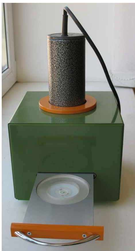
Рисунок 1 - Блок детектирования и устройство для экспонирования счетных образцов
