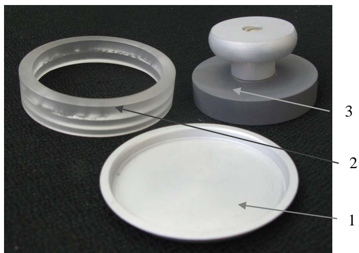
1 –измерительная кювета; 2 – направляющее кольцо 3 – ручной пресс
