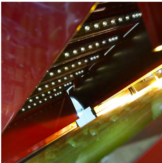
Рис. 3.4. Инфракрасная спектрометрия в процессе сортировки фруктов [ http://www.virtualmarket.fruitlogistica.de/de/INSCAN,p1123014 ]
