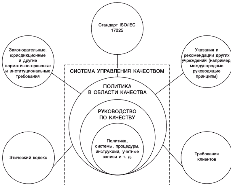
Рис. 1. Общая структура системы управления качеством в лаборатории
